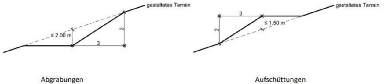
Abbildung 3 Aufschüttungen und Abgrabungen (§ 9.2 und § 35)
