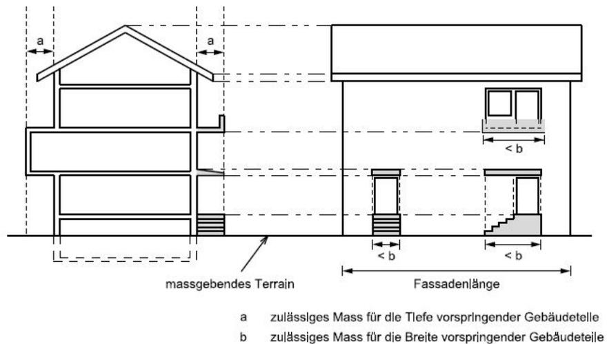
Abbildung 15 Rückspringende und unbedeutend rückspringende Gebäudeteile (§ 40)
