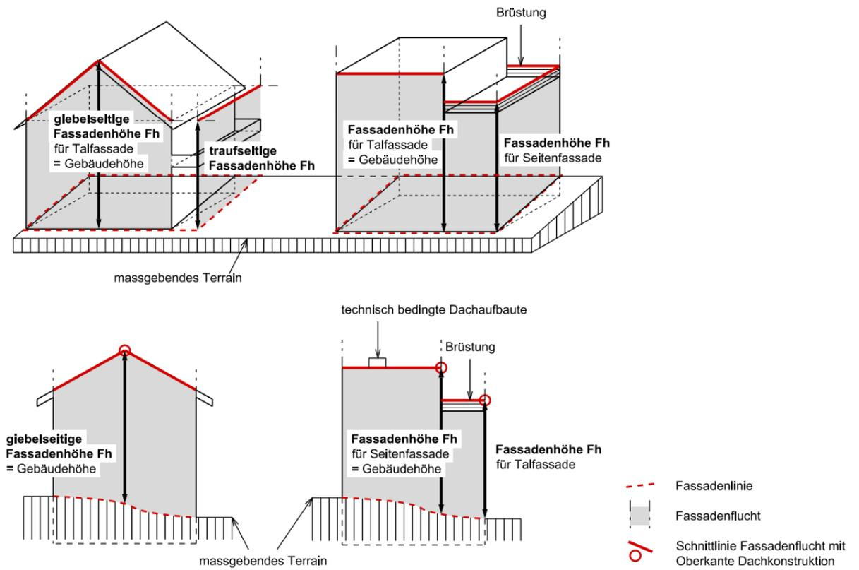
Abbildung 12 Fassadenflucht und Fassadenlinie (§ 40 und § 41)
