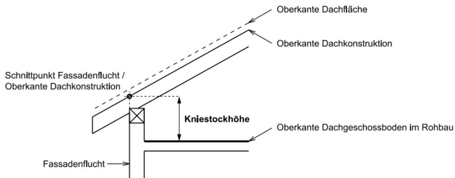
Abbildung 11 Fassaden- und Gebäudehöhe (§ 38 und 0)
